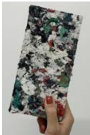
Brique textile aggloméré , FabBRICK 2019 © CLARISSE MERLET
