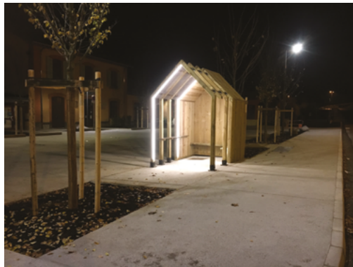
Léa Hermet & Léo Rabiet, Serra, banc, 2018. Pin classe 4, Tablettes HPL, tubes de structure en acier peint, toiture translucide, éclairages LEDS intégrés et câbles inox. © L.Hermet/L.Rabiet
